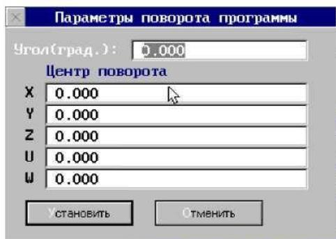
Диалоговое окно настройки подрежима обработки с поворотом программы вызывается с помощью кнопки **[F3-поворот...]** или функциональной клавиши «F3». Действия подрежима подобны действиям функции G37 (см. **Программирование управляющих программ**). Чтобы включить подрежим нужно ввести значение угла поворота (значение 0 отключает режим поворота). Центр поворота парой координат для соответствующей плоскости. Поворот программы выполняется только в плоскости, действующей в программе.
