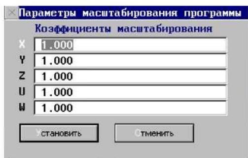
Используя кнопку **[F4-масштабирование...]** или функциональную клавишу «F4» вызывается диалоговое окно настройки подрежима обработки с масштабированием программы. Действия подрежима подобны действиям функции G69 (см. **Программирование управляющих программ**). Чтобы включить подрежим нужно ввести соответствующие коэффициенты по осям (значение 1 отключает режим масштабирования).
