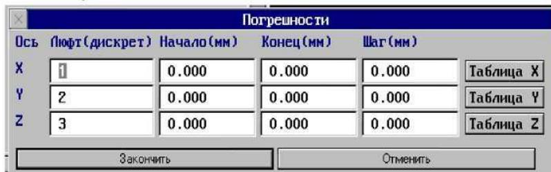
Значение люфта в дискретах измерительной системы вводится с помощью строк ввода «**Люфт**».
