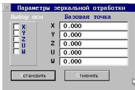
Параметры «**Выбор оси**» задают обработку программы с зеркальной обработкой заготовки по осям X, Y, Z и др. соответственно (действия аналогичны функции G67 (см. **Программирование управляющих программ**)). Для включения зеркальности нужно установить соответствующий элемент кластера и ввести базовую точку. Понятие «**Зеркальная обработка по оси**» значит: все перемещения, запрограммированные для оси, по которой задана зеркальная обработка, будут выполняться
