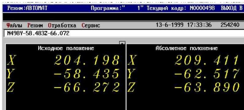
При установке способа выхода в исходное положение "Позиционирование" движение координат происходит в соответствии с выбранными осями и используется для выхода в начало найденного при поиске кадра. Использование способов "Обратным ходом" и "Обратным ходом по шагам" значимо лишь для возврата на
