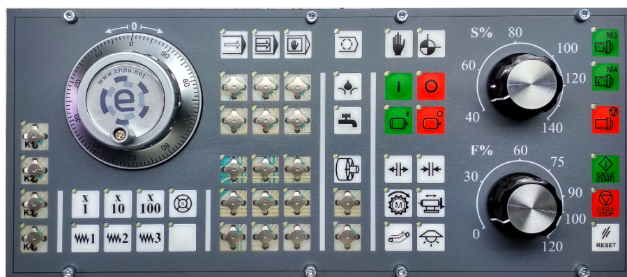
Рис. 3.4.1: Станочный пульт оператора
