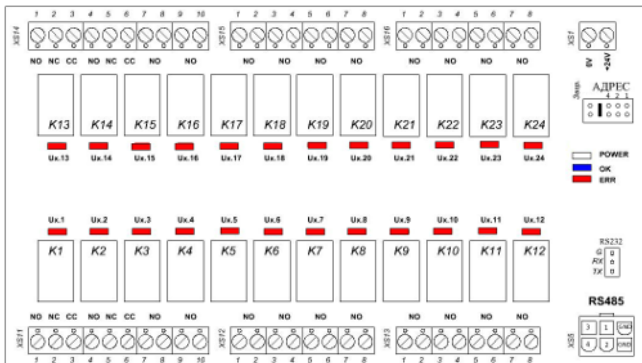
Рис. 3.6.2: Схема подключения OUT24
