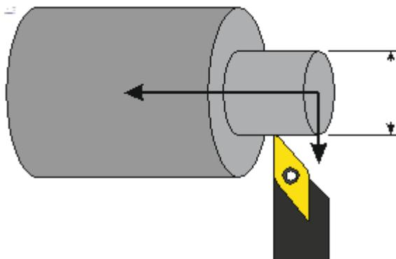
Рис. 1.4.3: Ручная привязка инструмента на токарной версии ЧПУ
