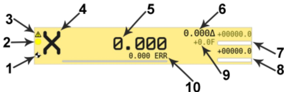
Рис. 1.1.9: Структура поля индикации оси
