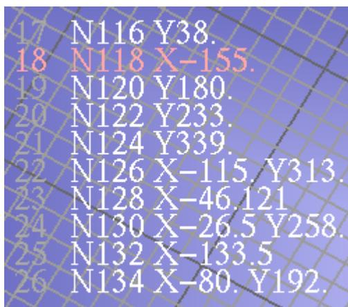
Рис. 1.3.9: Текст программы, отображаемый в окне графического просмотра
