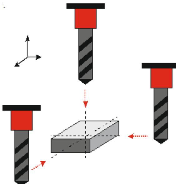
Рис. 1.4.7: Автоматическая привязка инструмента на фрезерной версии ЧПУ
