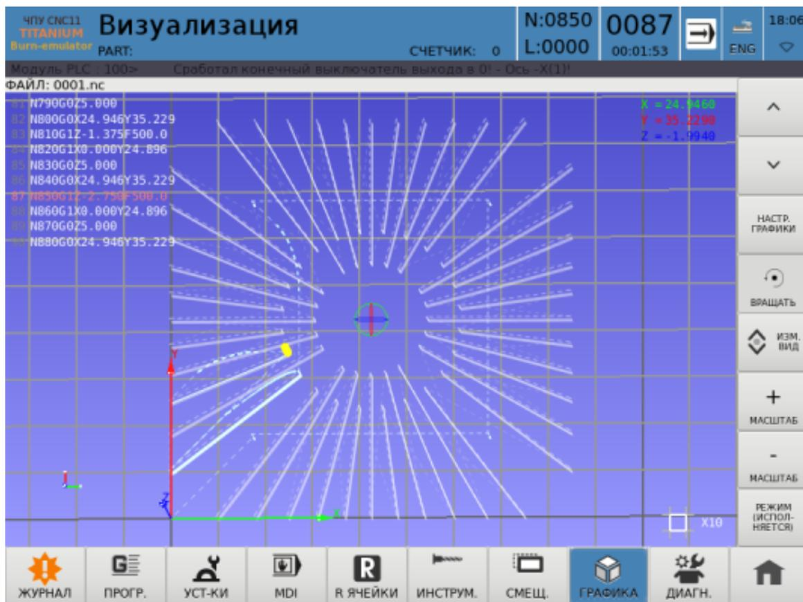
Рис. 1.3.3: Окно графического просмотра в режиме станка
