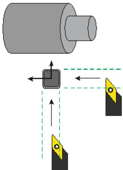
Рис. 1.4.5: Автоматическая привязка инструмента на токарной версии ЧПУ
