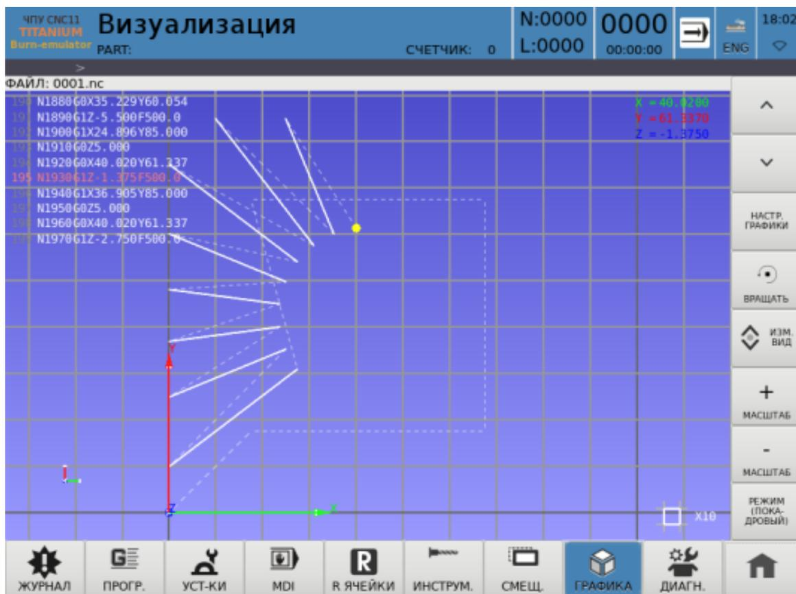
Рис. 1.3.4: Окно графического просмотра в покадровом режиме
