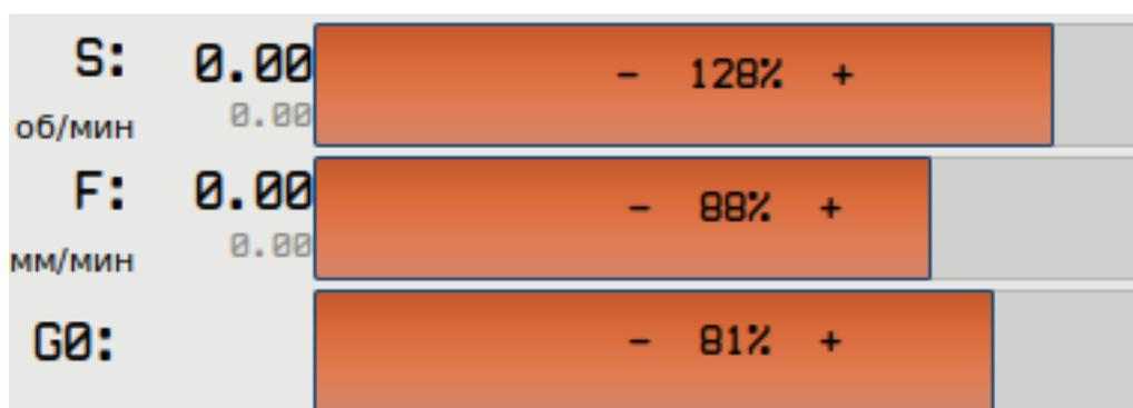
Рис. 1.1.12: Поле индикации скоростей и оборотов
