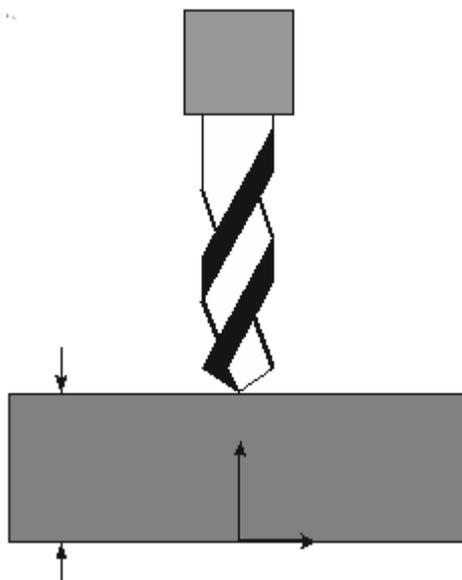
Рис. 1.4.6: Ручная привязка инструмента на фрезерной версии
