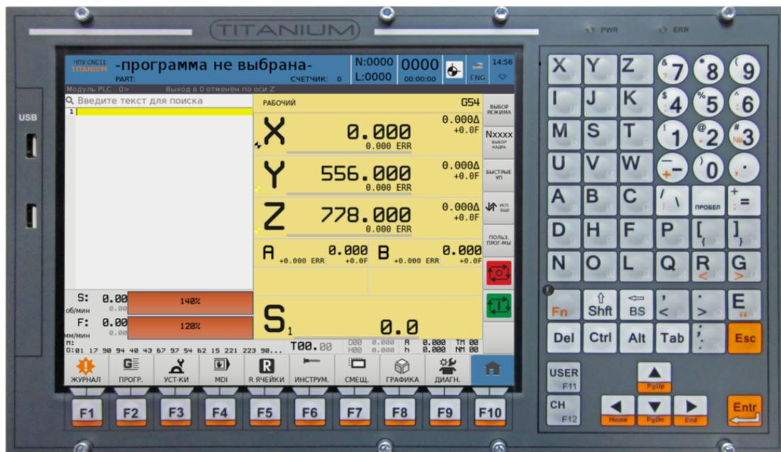
Рис. 1.1.1: Внешний вид лицевой панели ЧПУ TITANIUM®
