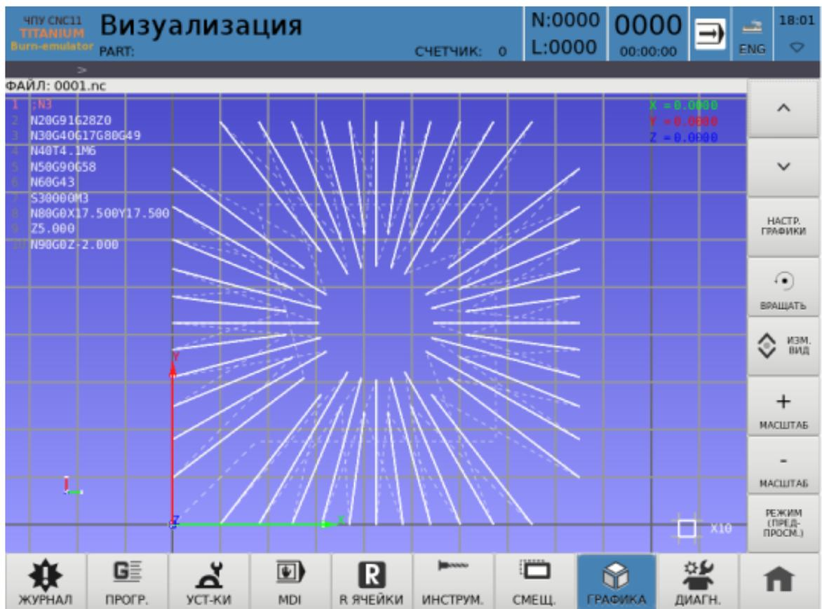
Рис. 1.3.5: Окно графического просмотра в режиме предпросмотра
