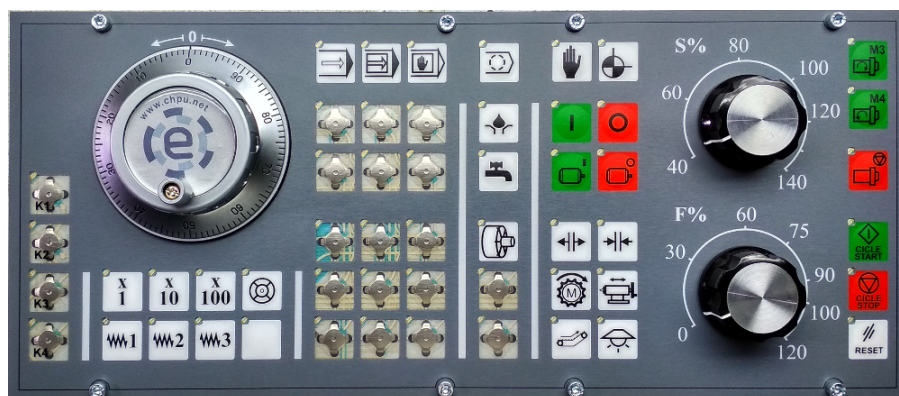
Рис. 3.4.1: Станочный пульт оператора
