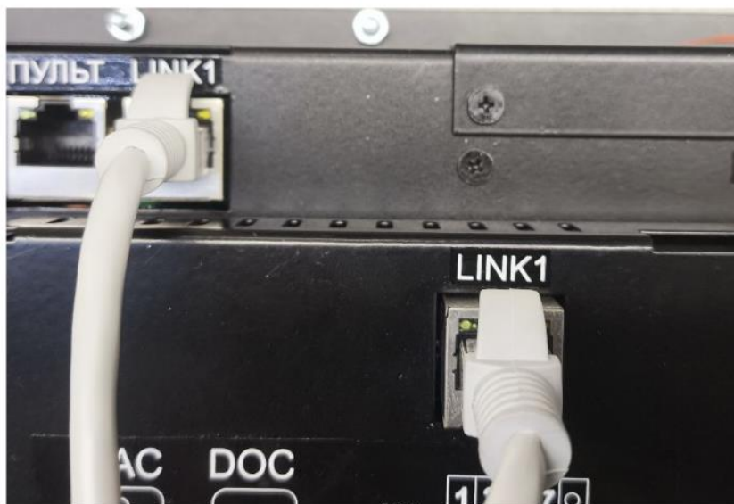
Рисунок 25 – разъемы для подключения платы CNC12 к системе ЧПУ TITANIUM
